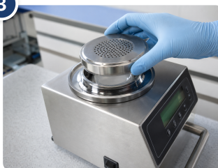
Remise en place du crible
